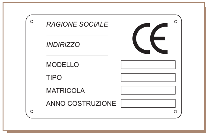
Fig. 2 - Esempio di targa di un cancello motorizzato.
